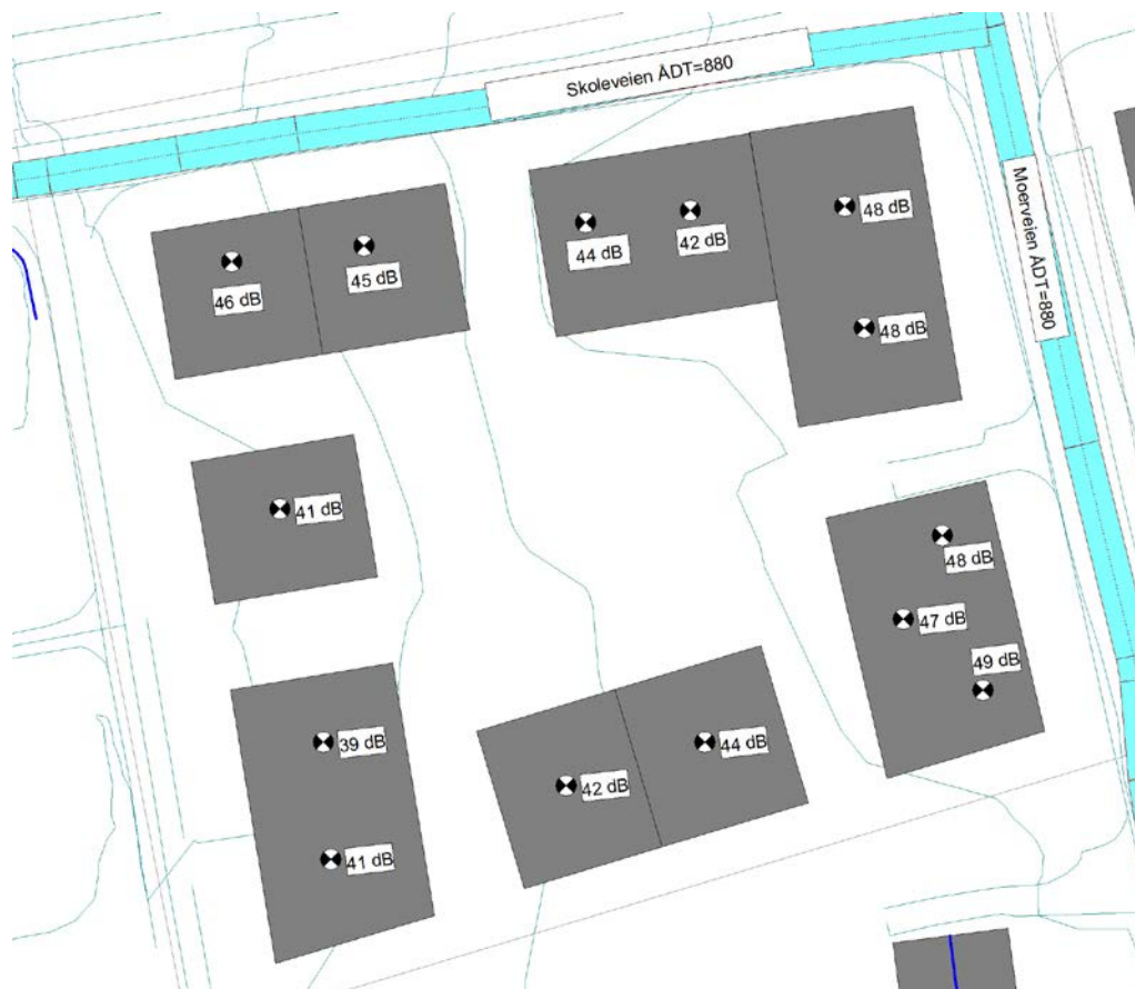
Figur 4 - Beregnet støynivå, L_{den} , på tak. Verdier er beregnet 1,5 meter over terrassegulv og er oppgitt i dB.
